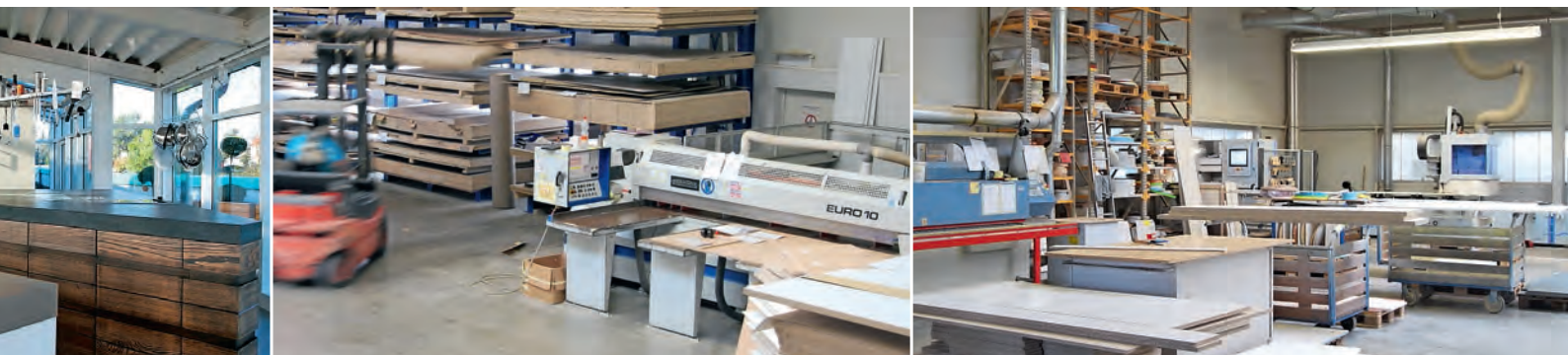
Die Fertigung ist unspektakulär, aber effizient: Euro 10 von Panhans, Kantenanleimmaschine von Ott, Weeke-BAZ
